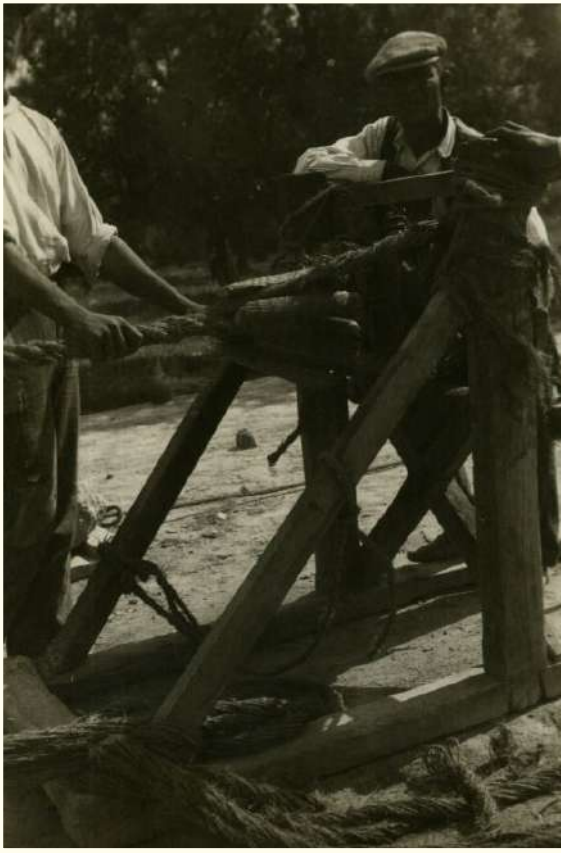
Dos trabajadores corchando una maroma de esparto en una fábrica espartera de Cieza. Año 1950.
